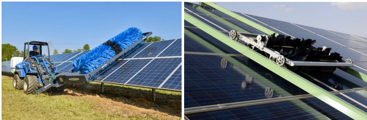
Rys. 15 Nowoczesne technologie mycia paneli PV (Źródło: solarpowerworldonline.com)
