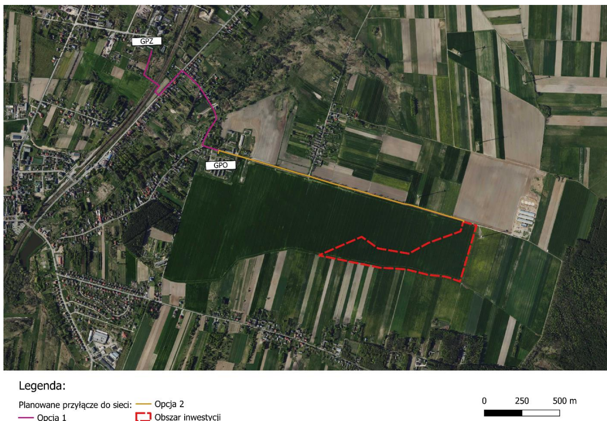
Rys. 11 Przykładowe warianty przyłączenia do Krajowego Systemu Elektroenergetycznego
